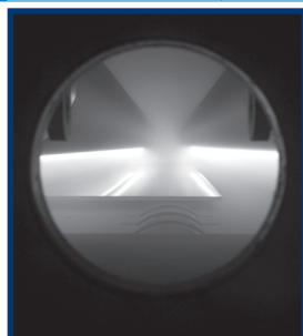
Processo di Magnetron sputtering
